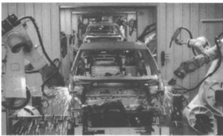
图 48 德国大众汽车激光机器人焊接车身生产线
